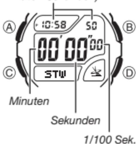
Mit der Stoppuhr können Sie die abgelaufene Zeit, Zwischenzeiten und zwei Endzeiten messen.
